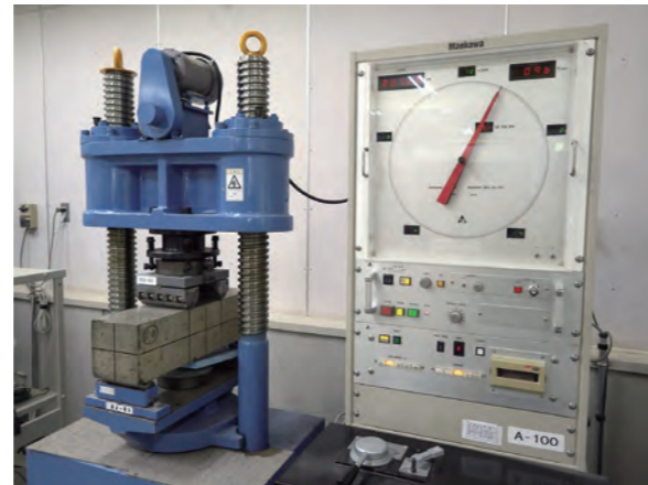
道路、空港などのコンクリート舗装の品質を検査
