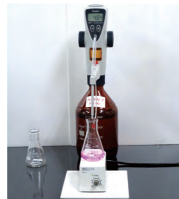
骨材のアルカリシリカ反応性を、化学的な方法によって比較的迅速に判定する試験
