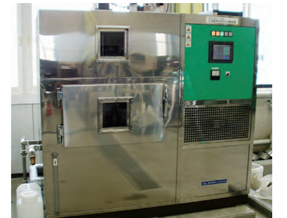
硝酸ナトリウムの結晶圧による破壊作用を応用した骨材の凍結融解抵抗性に対する耐久性試験
