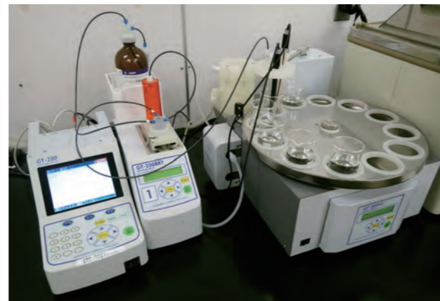
骨材中の塩化物イオン濃度を、塩化物イオン電極を用いた電位差滴定により測定
