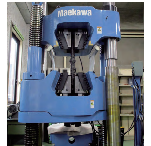
各種機械的性質(降伏点、引張強さ、破断伸びなど)を測定 ※呼び径D6～D51対応可能
