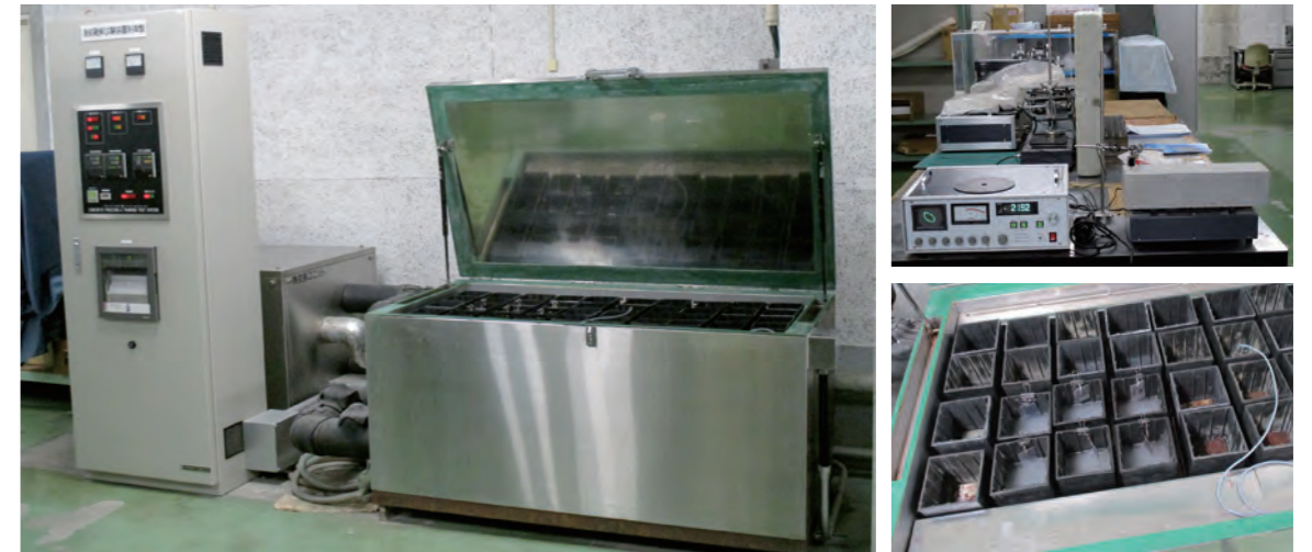
コンクリートの凍結融解に対する抵抗性を、供試体を用いて凍結融解(-18℃~+5℃)の急速な繰り返しによって試験
